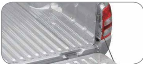
Um compartimento do motor mais rígido e uma patilha dupla no mecanismo de segurança contribuem para uma maior durabilidade e segurança. Na caixa de carga, os cantos traseiros são reforçados para dispersar a força do impacto, evitando-se assim estragos nos painéis laterais.
